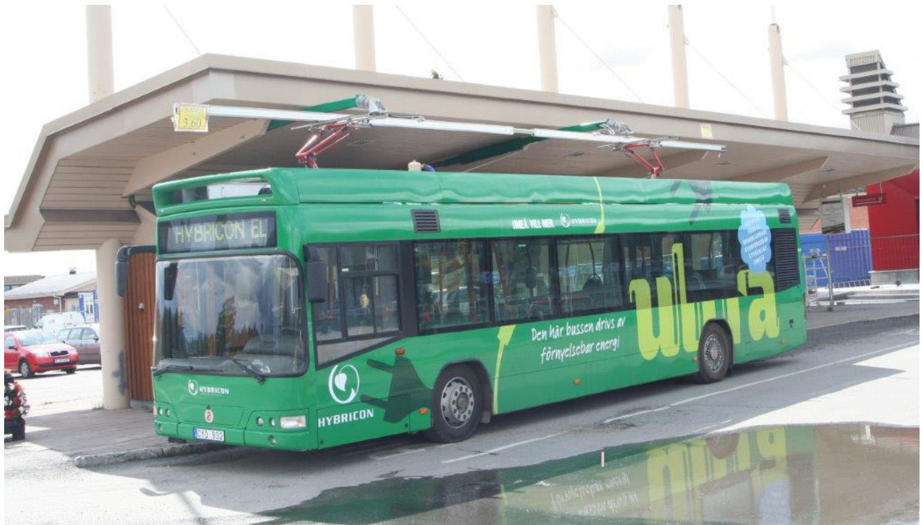
Figur 5: Buss som lades via pantograflading. Foto: Frode Krokstad/AtB
