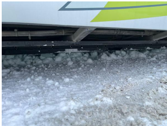
Figur 13 – Statisk lading fra snødekket veibane med ~10 cm ekstra snø mellom ladesegment og mottaker (Bilde: Electreon)
