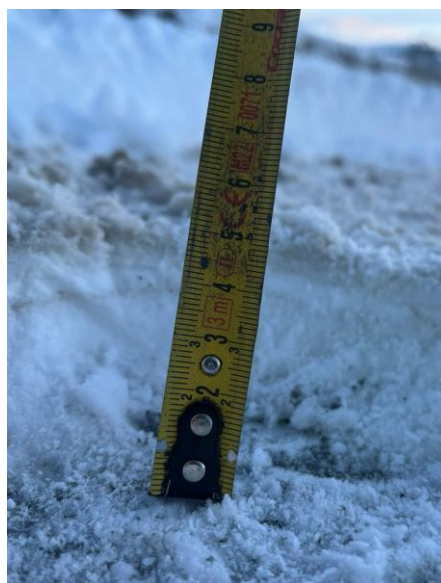
Figur 8 – Såle av snø og is i hjulsporene (Bilde: Electreon)
