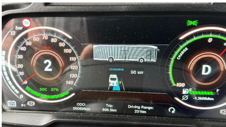
Figur 19 – Indikator for bussens sideveisplassering ift. ladefeltet i bussens dashboard. I dette eksempelet er bussen plassert for langt til venstre i veibanen.
