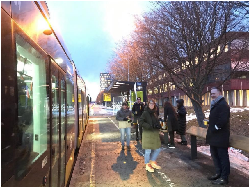
Figur 5 Ønsket posisjonering inntil kantstein for å innfri BRT-krav om vertikal og horisontal høyde fra kantstein. Her utmerket levert ved åpning av Sluppen stasjon 17.02.2020
