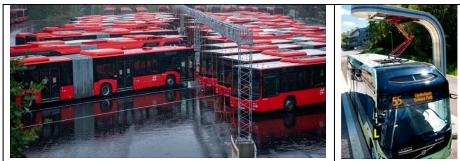
Figur 0-9: Bussdepot i Oslo. Kilde: Ruter. Eksempel på pantograf ved endeholdeplass. Kilde Siemens/TU
