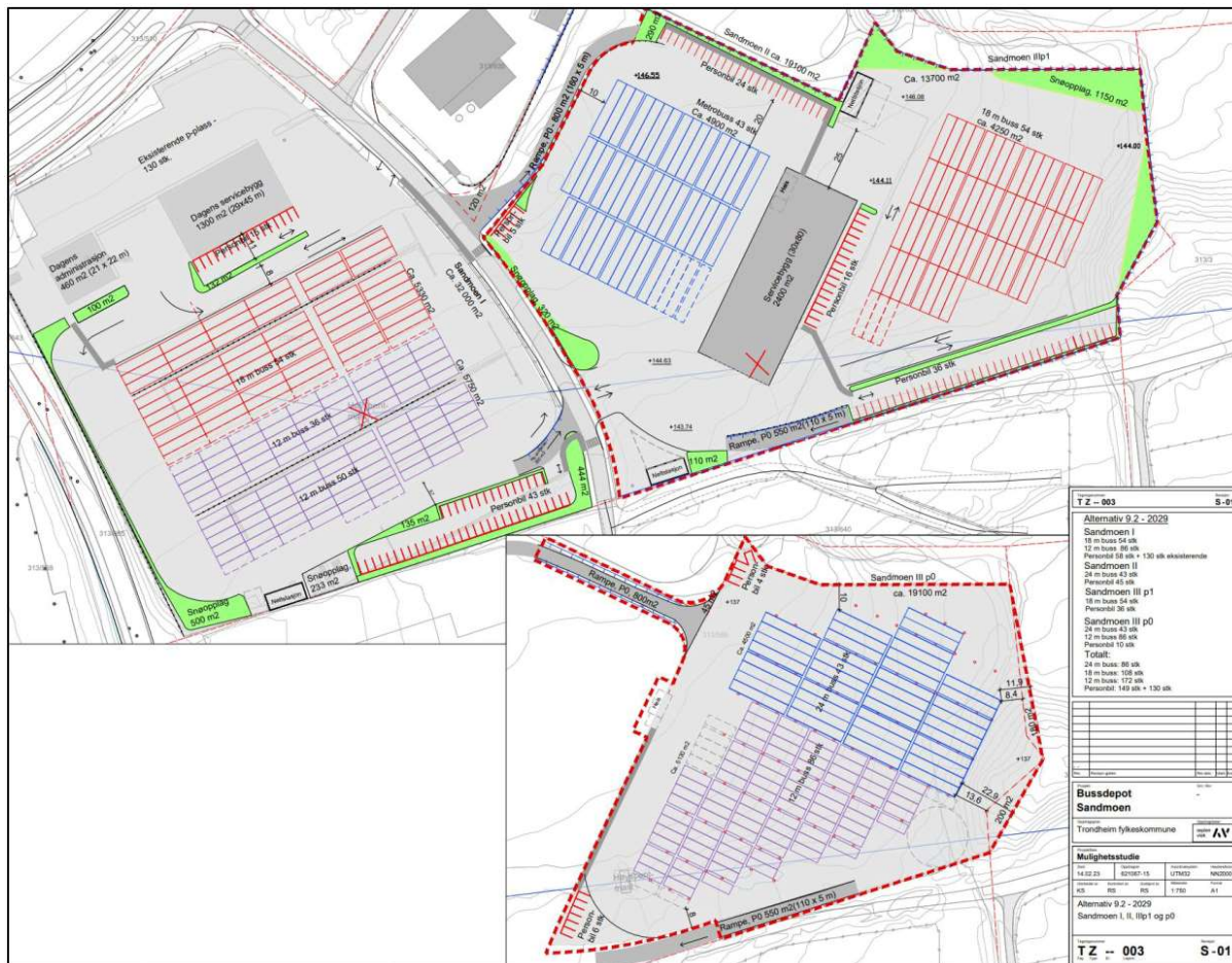
Figur 3-1 Illustrasjon over anbefalt alternativ 9.2 fra mulighetsstudien som viser to adskilte depot med to operatører som løser behovet for 365 busser i 2029.
